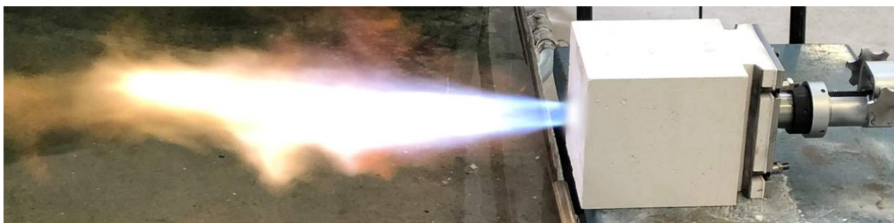
Funcionamiento del quemador en el horno de prueba (la llama es visible aquí, pero una llama de alta temperatura es casi invisible)
